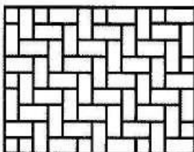
Figura 8 – Assentamento das peças de concreto tipo espinha de peixe
